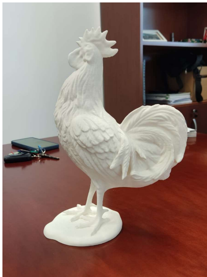
Resultado de la fotogrametría. Gallo impreso en 3D a partir de la digitalización y el escaneo previos
